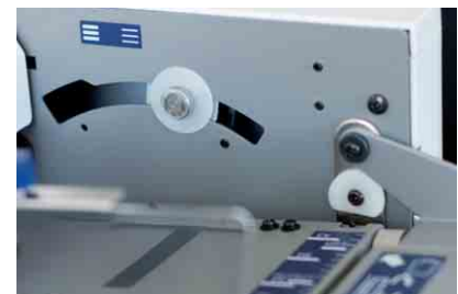
Justiermöglichkeit für unterschiedliche Papierstärken
