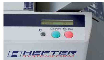
Übersichtliches Bedientableau mit Display und 4-stelligem Jobzähler
